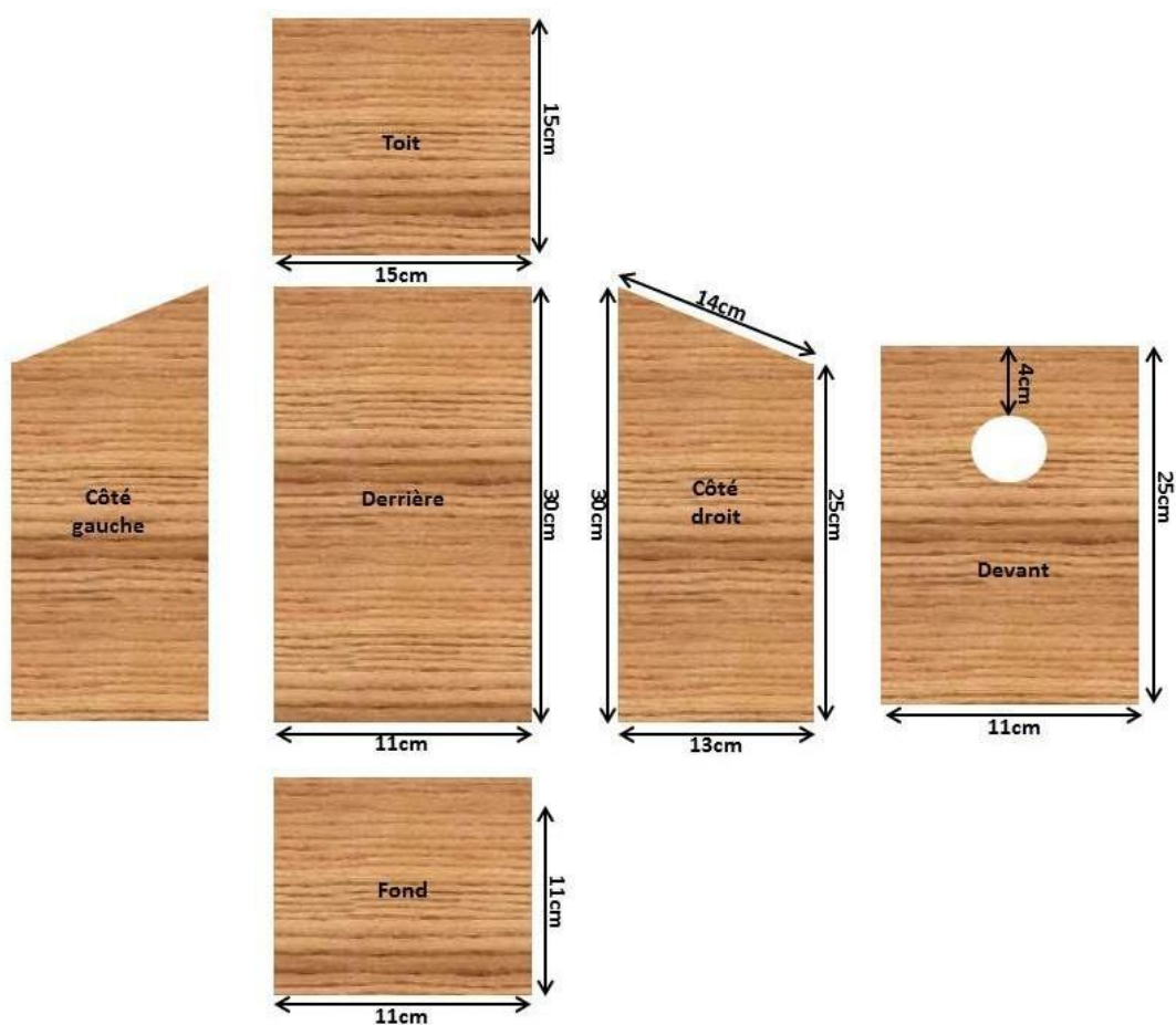
Figure 1. Plan pour construire un nidhoir à mésange
